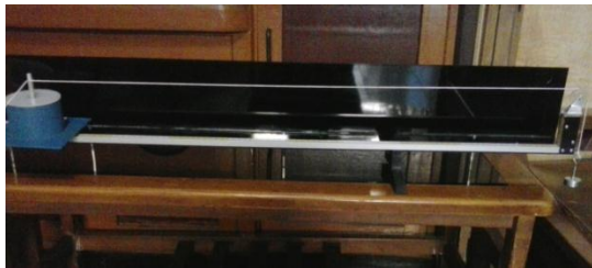
Gambar 1. Desain rangkaian alat praktikum Melde
