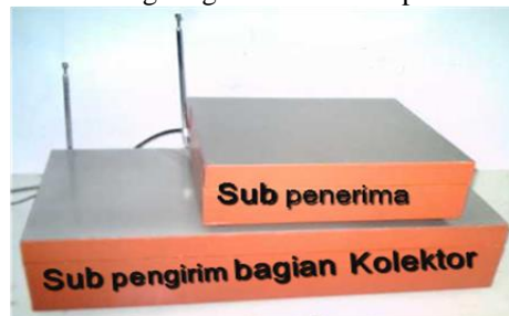
Gambar 4 Wujud Fisik Box Sub Kolektor dan Sub Penerima
